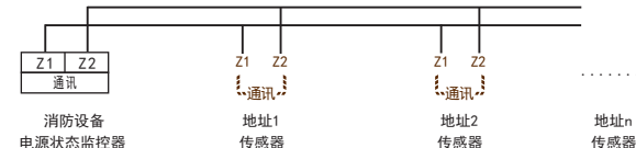
图二 一般环境推荐 采用双绞线 特殊环境推荐 采用屏蔽双绞线
